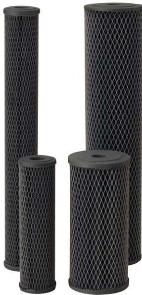
Los Cartuchos Serie NCP Pentair Pentek\* están fabricados de material impregnado en carbón sin celulosa. Estos filtran los sedimentos y reducen el sabor y el olor, y el sabor y el olor del cloro en un cartucho. A diferencia de los cartuchos de celulosa, los Cartuchos Serie NCP se pueden usar para aplicaciones residenciales y de agua sin cloro.
